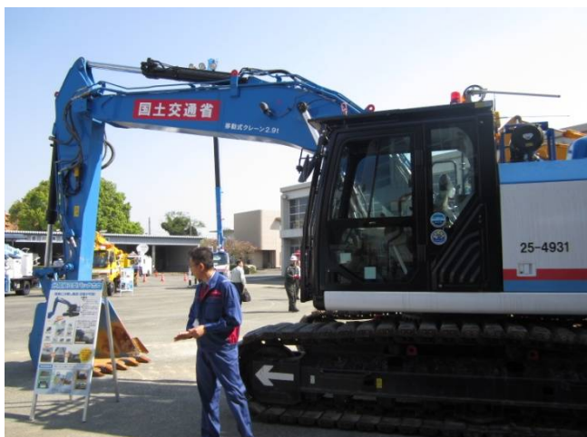
分解組立型バックホウ(遠隔操作式) : 土砂災害現場等で作業員の安全確保、二次災害の防止と迅速な災害復旧作業を行なう為、容易な分解・組立により空輸、遠隔操作も可能な大型機械(バックホウ 1.0m 3 ) 遠隔操作範囲 約150m。緊急時には12ブロック(17ブロック最大2.8t)に分解して危険な現場に陸送・ヘリコプターでの空輸が可能。分解・解体には特殊な工具を使用せず、現地での作業が可能で、危険な災害現場で有用な遠隔操作装置を装備している。
