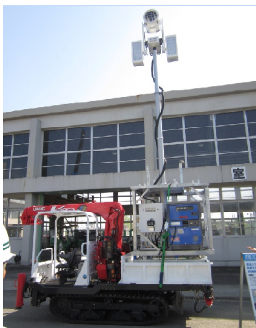
照明車 : 夜間や豪雨など、悪条件下で行われる災害復旧活動に良好な視界を確保する。照明灯下部の高感度カメラで捉えた現場状況を対策本部へ送信できる。
