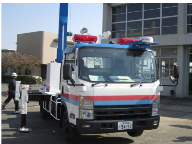
照明車 : 夜間や豪雨など、悪条件下で行われる災害復旧活動に良好な視界を確保する。照明灯下部の高感度カメラで捉えた現場状況を対策本部へ送信できる。
