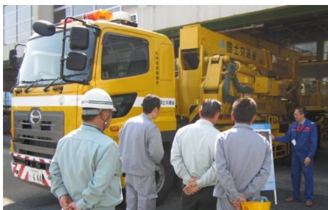
橋梁点検車 : 橋梁下面の現状を作業状態で走行しながら異常、損傷の早期発見を行う。災害時には高所、低所からの情報収集にも活躍。
