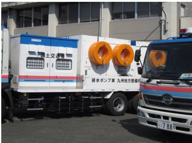
排水ポンプ車 : 強力ポンプを使って内水を本川側へ迅速に排水、内水被害を軽減して、1分間に30m 3 の排水力で25mプール(約400m 3 )を12分30秒で空っぽにする機能を持つ。
