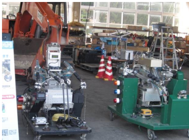
簡易遠隔操縦装置(ロボQ) : 汎用のバックホウ・ブルドーザー・クローラーダンプに簡単に装着でき危険区域内作業を無人で行える。
