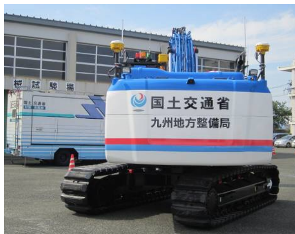
分解組立型バックホウ(遠隔操作式) : 土砂災害現場等で作業員の安全確保、二次災害の防止と迅速な災害復旧作業を行なう為、容易な分解・組立により空輸、遠隔操作も可能な大型機械(バックホウ 1.0m 3 ) 遠隔操作範囲 約150m。緊急時には12ブロック(17ブロック最大2.8t)に分解して危険な現場に陸送・ヘリコプターでの空輸が可能。分解・解体には特殊な工具を使用せず、現地での作業が可能で、危険な災害現場で有用な遠隔操作装置を装備している。
