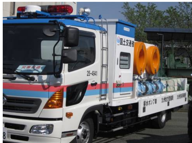
排水ポンプ車 : 強力ポンプを使って内水を本川側へ迅速に排水、内水被害を軽減して、1分間に30m 3 の排水力で25mプール(約400m 3 )を12分30秒で空っぽにする機能を持つ。
