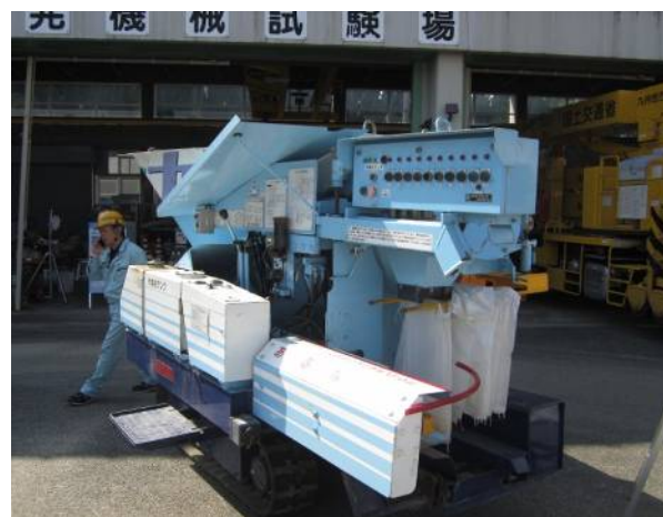
土のう造成機 : 大量の「土のう」が短時間で、しかも自動操作で作られ災害現場での大幅な省力化が期待できる。(180袋/時間)
